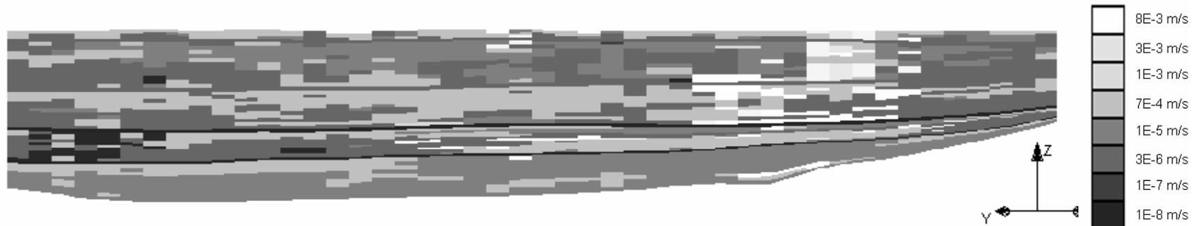
Figura 2-35: distribuzione delle permeabilità a fine taratura, sezione trasversale I15
