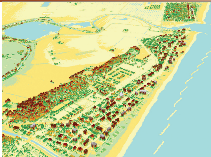
Figura 4 Visualizzazione tridimensionale del DSM della costa a sud della foce del Fiume Savio. Sono facilmente riconoscibili elementi come edifici e copertura arborea
