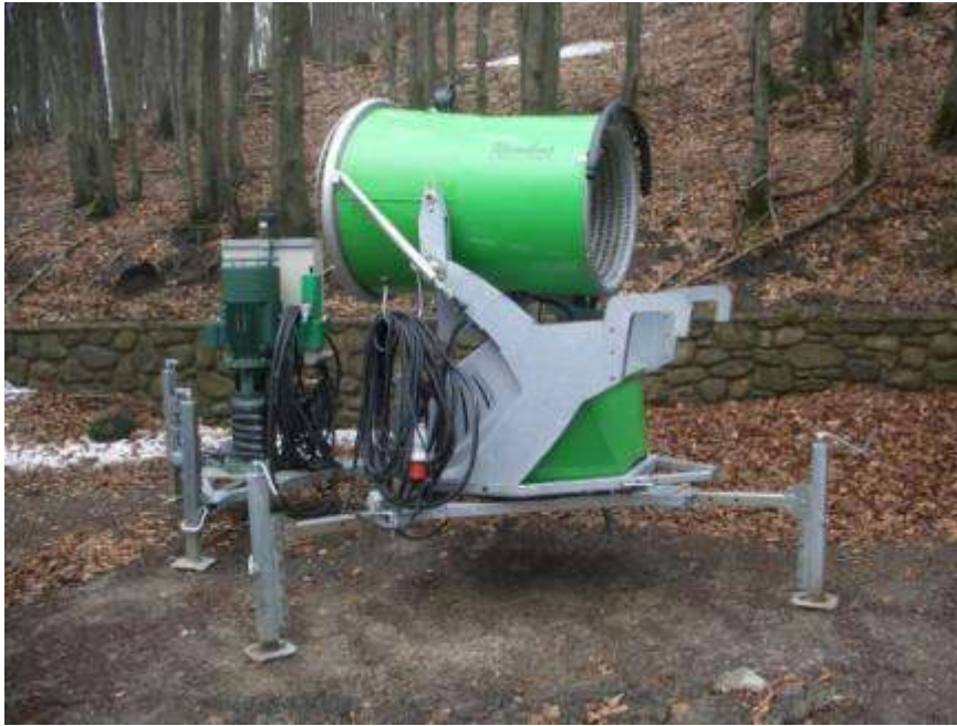
Figura 13 – Cannone ad alta pressione per neve tecnica artificiale in uso presso le piste
