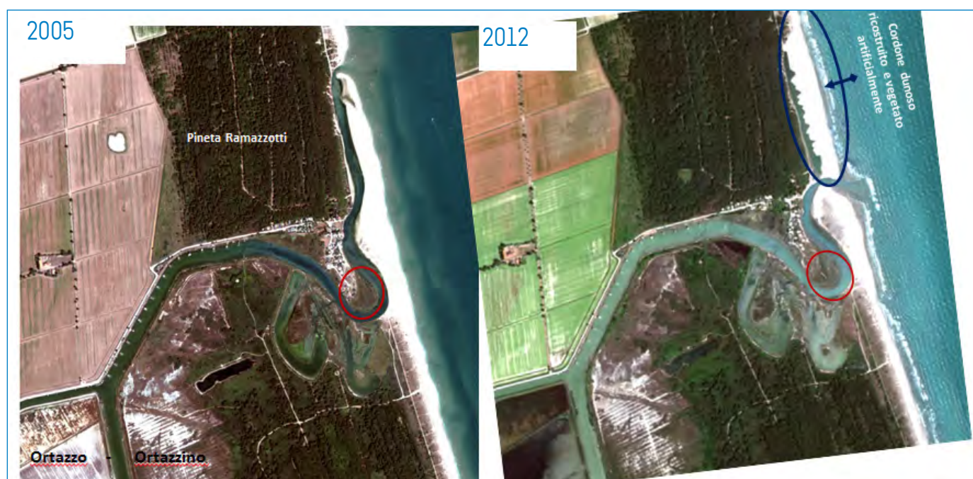
Figura 82 Intervento di modifica della foce e costruzione della una duna artificiale vegetata e retrostante stagno retrodunoso. In rosso è evidenziata l'area di salvaguardia della Salicornia veneta .
