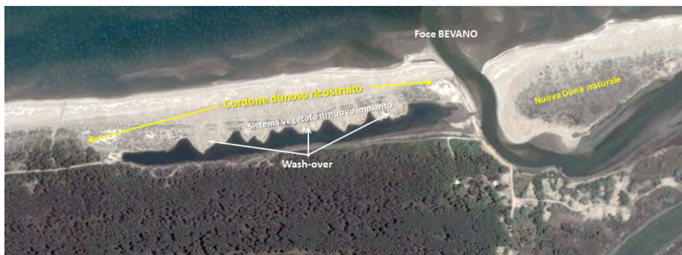
Figura 85 La foto aerea evidenzia la formazione di ventagli di washover a tergo della duna ricostruita.
