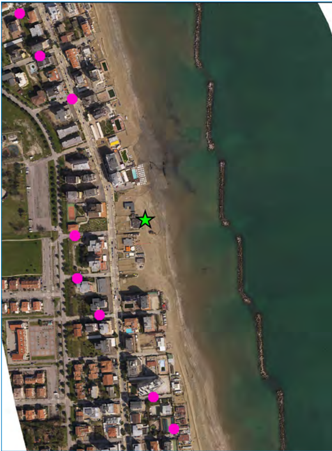
Figura 37 Lido di Classe (foto aprile 2010): i punti viola indicano le evidenze di sommersione marina più avanzate verso terra a seguito della mareggiata del 31 ottobre 2012; la stella indica il punto di ripresa della foto di figura 38.
