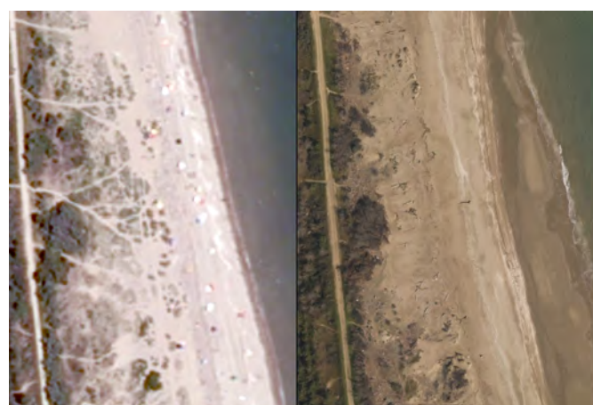
Figura 36 Immagini del 2008 (a sinistra) e di aprile 2010 (a destra) post-evento a nord di foce Bevano: confrontando la porzione centrale e quella superiore delle immagini si può osservare la distruzione della duna con conseguente spianamento delle morfologie.
