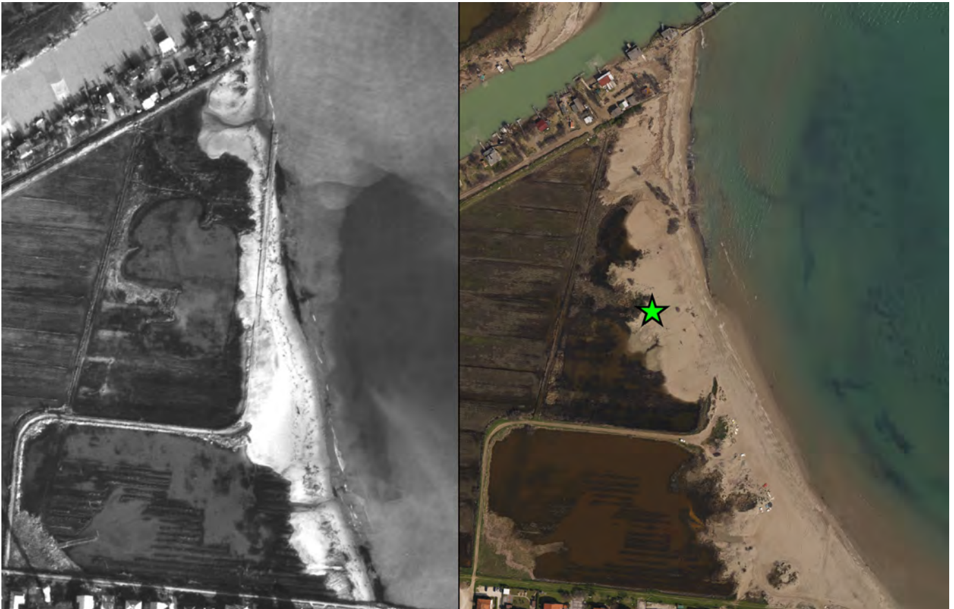
Figura 31 Foto aeree della foce F. Uniti sud, dicembre 1992 (sinistra), aprile 2010 (destra); si notino i numerosi ventagli di washover; la stella verde indica il punto di ripresa della foto di figura 32.
