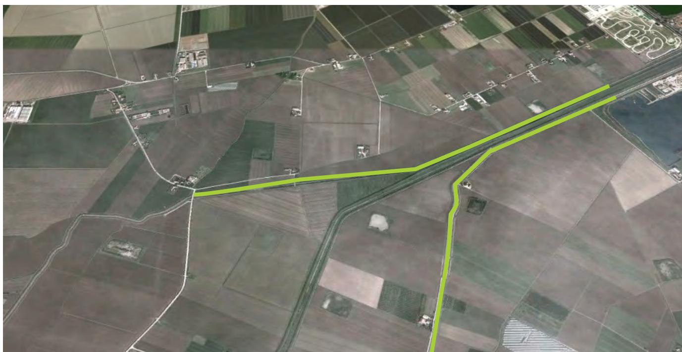
Figura 62 Schema del progetto di unione degli alvei fra il T. Bevano e i canali di bonifica Bevanella e Acquarola.
