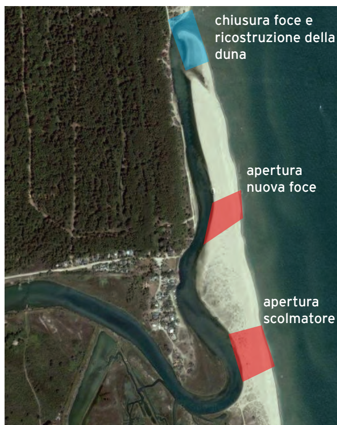
Figura 4 Intervento di sistemazione della foce Bevano. Rappresentazione schematica delle principali aree di intervento e delle opere realizzate.
