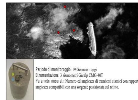
Figura 7 - Localizzazione delle tre stazioni microsismiche installate nei pressi di Punta Gabbianara e immagine dello strumento.
