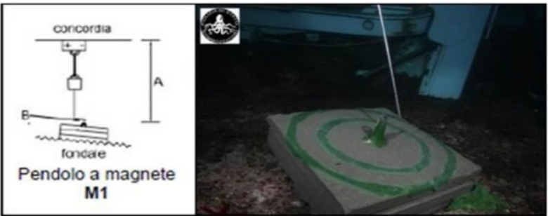
Figura 12 - Rappresentazione schematica ed immagine del marker M1.
