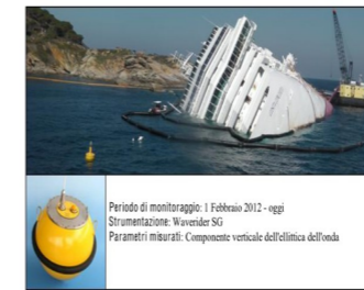
Figura 17 - Localizzazione e immagine della boa ondometrica installata in prossimità della nave.
