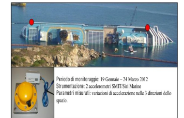
Figura 2 - Localizzazione degli accelerometri installati sulla nave e immagine dello strumento.
