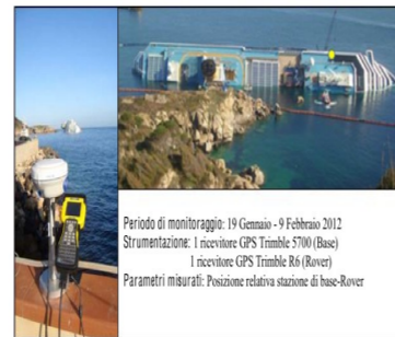
Figura 9 - Localizzazione della stazione di base GPS installata sulla nave e immagine del Rover installato a terra.
