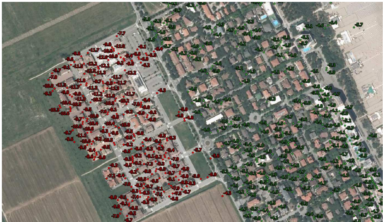
Fig. 38 - Esempio di un cluster che evidenzia il movimento anomalo di una nuova urbanizzazione
