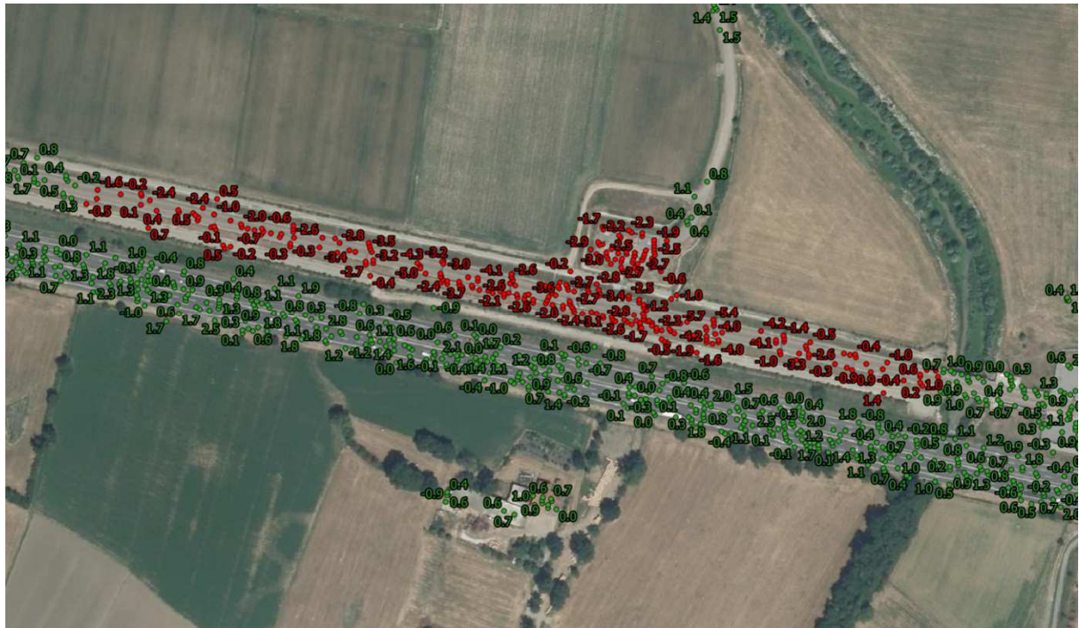
Fig. 37 - Esempio di un cluster che evidenzia il movimento anomalo di una infrastruttura
