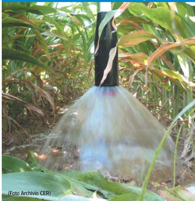
Foto 1 - Particolare di diffusore LEPA su sorgo.
