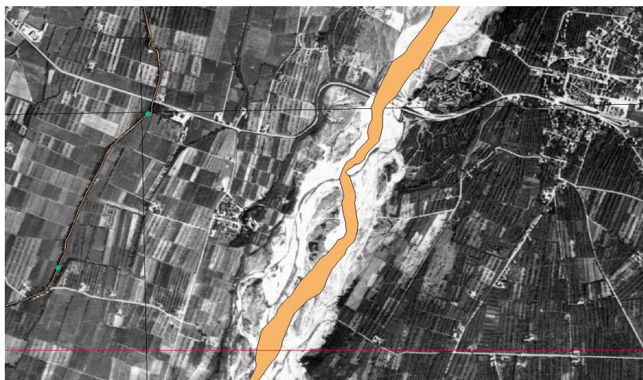
Figura 2.3 Sovrapposizione per un tratto dell'Enza all'altezza di Montecchio Emilia tra il rilievo 1954-'55 e la delimitazione attuale dell'alveo (perimetrazione colorata)
