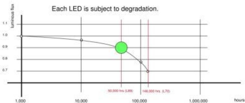
I produttori LED, in base alle indicazioni contenute nei documenti IEC, devono fornire, oltre all'indicazione della perdita percentuale di flusso nel tempo, anche l'indicazione del *failure rate* relativa ad ogni diodo luminoso (ovvero quale percentuale della popolazione dei diodi mantiene il flusso luminoso indicato); in generale l'indicazione riporta la percentuale di flusso residua dopo un determinato periodo e la percentuale di diodi che mantengono le caratteristiche indicate senza rompersi.
