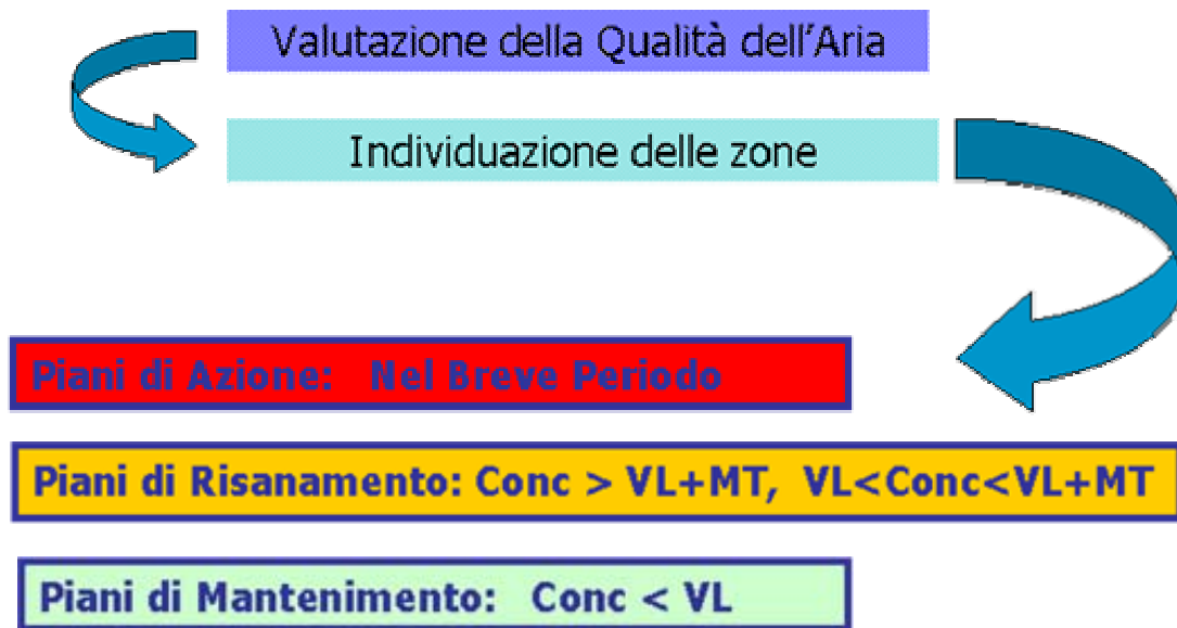
Fig. 2.1 – Schema per il percorso di azione da intraprendere in funzione dei valori delle concentrazioni di inquinante stimate rispetto ai limiti della normativa
