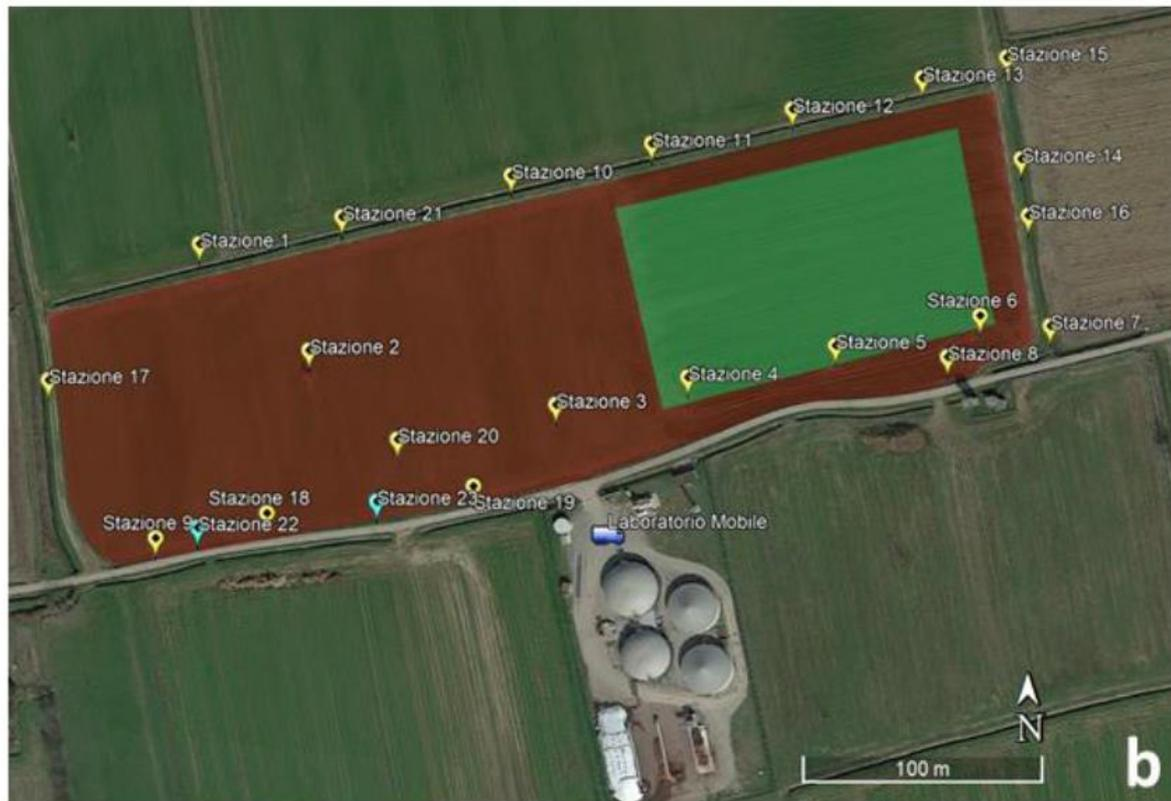
Campo agricolo oggetto di spandimento durante la campagna di monitoraggio. Nelle figure sono mostrati le porzioni di terreno soggette a spandimento superficiale (in rosso) e quelle oggetto di spandimento interrato (in verde); sono indicate, inoltre, le posizioni delle stazioni di campionamento passivo installate.
