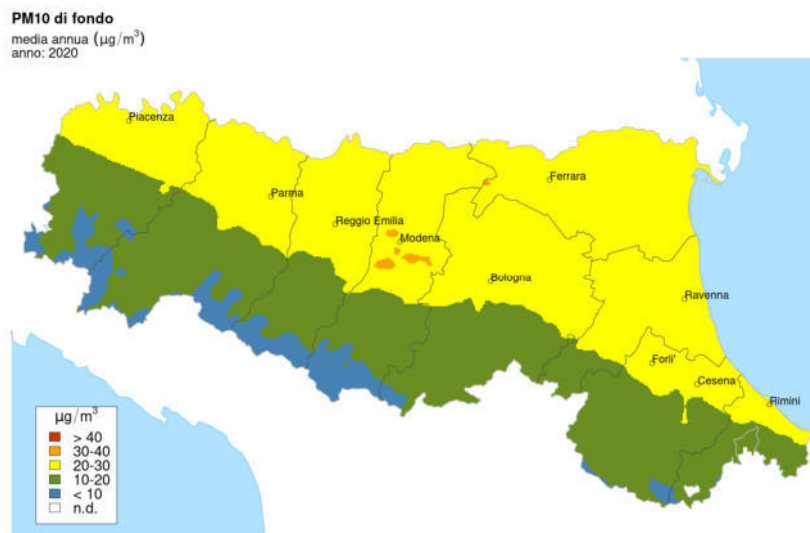
Figura 22e. Valutazione modellistica della concentrazione media annuale di fondo del PM10 per l'anno 2020.
