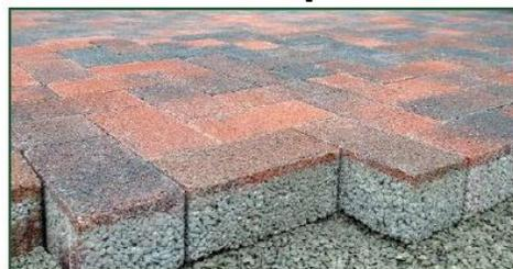
La pavimentazione viene posata su un sottostante strato portante in ghiaia mediamente di 20 cm di altezza e direttamente su un letto di pietrisco di 3-5cm di altezza. Le fughe larghe e gli spazi possono essere riempiti di aggregati, sabbia o di terriccio dove si può poi insediare un tappeto erboso. Tipologia adatta anche a traffico pesante; aree di stoccaggio e movimentazione, parcheggi, piste ciclabili e pedonali, cortili, spiazzi, strade d'accesso, stradine.
