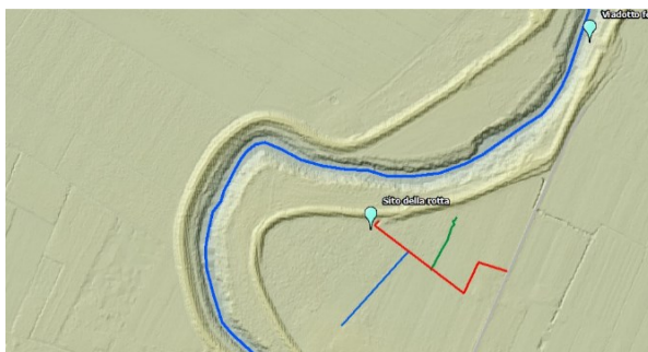
Figura 99. Rilievo LIDAR ad alta risoluzione della zona della rotta e rete di scolo storica e tuttora presente sul territorio (a sinistra). Il grafico a destra mostra il profilo altimetrico lungo il collettore principale (linea rossa nella figura a sinistra) utilizzando, sia il rilievo ad altissima risoluzione (arancio) che il classico rilievo a risoluzione 2 metri, tratto dal Piano nazionale di telerilevamento di Minambiente. Si osserva chiaramente come lo scolo delle acque converge a pochi metri dal sito della rotta, che si presenterebbe quindi come un sito di ristagno delle acque.
