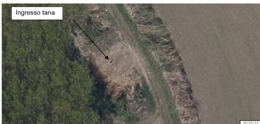
Figura 43 Immagine aerea obliqua dell'ingresso della tana che ha dato luogo al collasso parziale.
