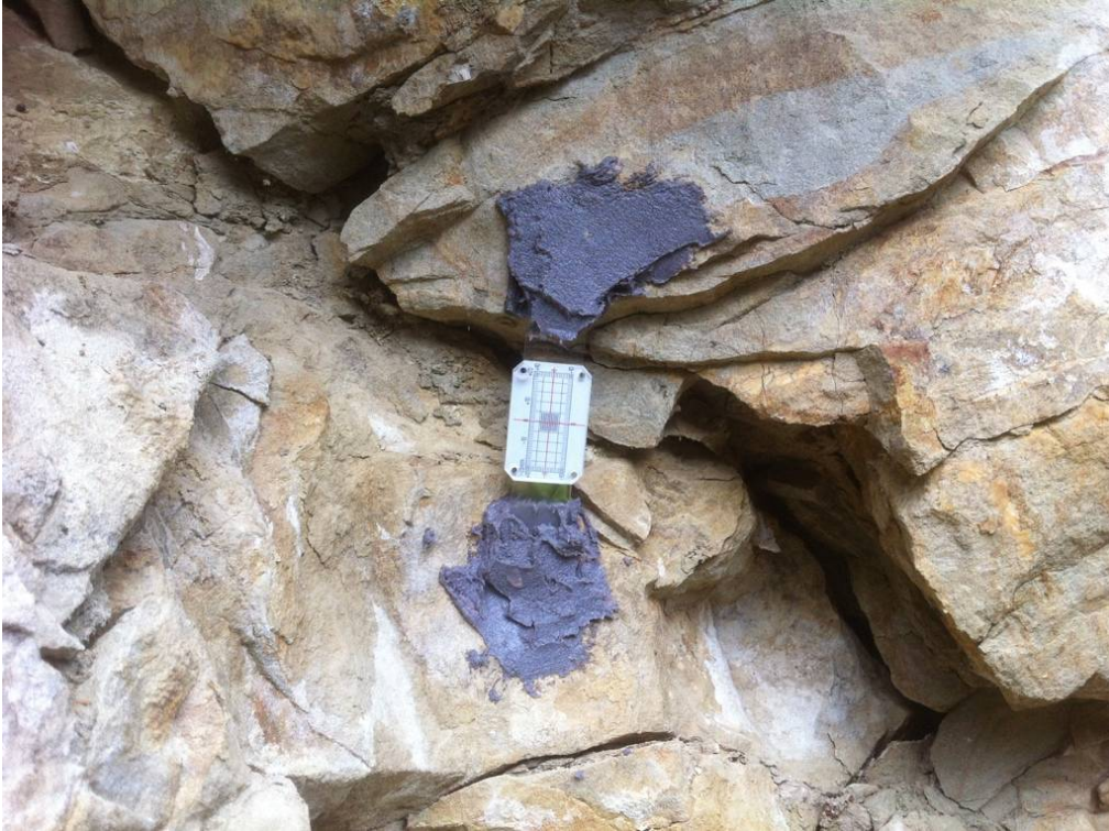
Posizione fessurimetro (le lettura successive del 7,8 e 9 settembre non hanno riscontrato movimenti)
