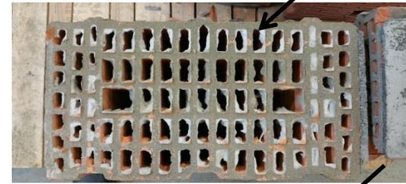
Rottura ottimale (nello spessore)
