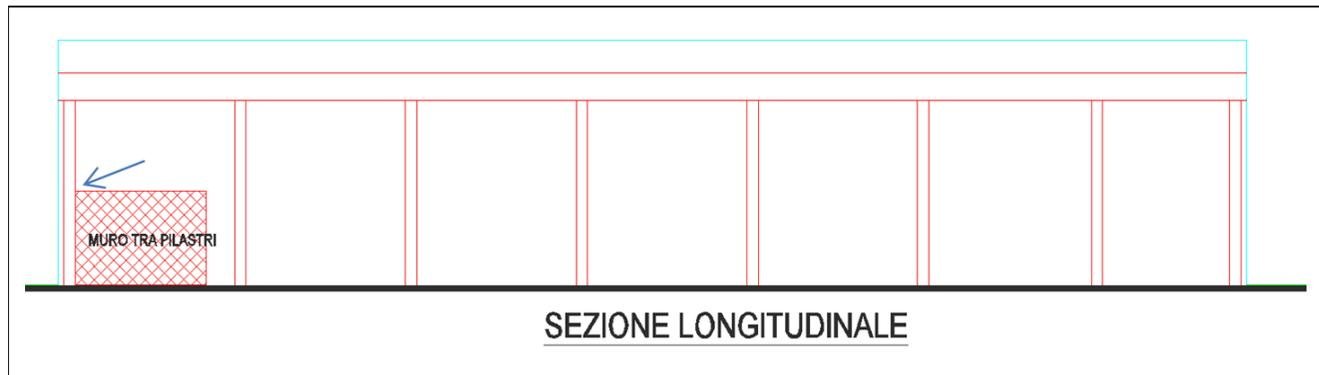
La freccia riporta la nascita del nuovo vincolo in caso di sisma in direzione X => cambiamento della rigidezza alla traslazione del pilastro in seguito alla creazione del nuovo vincolo:
