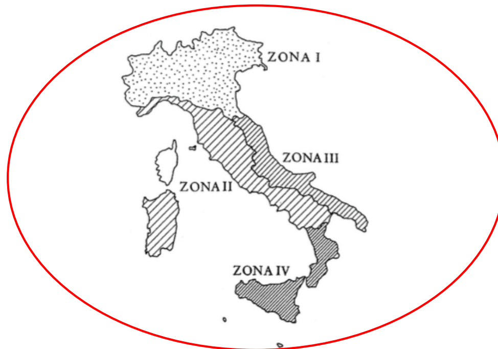
Fig. 3.5.1 – Zone della temperatura dell'aria esterna.
