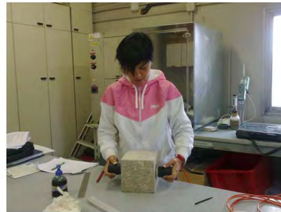
Fig. 2. a) Pressa per prove di schiacciamento e prova sclerometrica; b) prova ultrasonica
