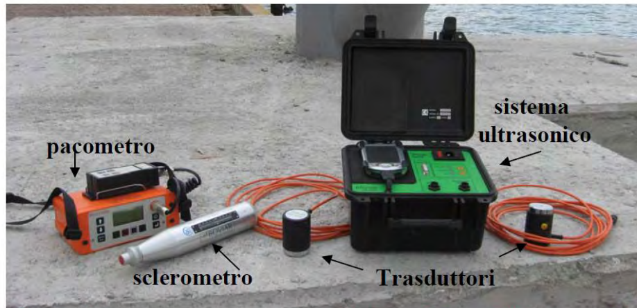
Fig. 1 - Sclerometro e strumentazione di misura delle velocità ultrasoniche
