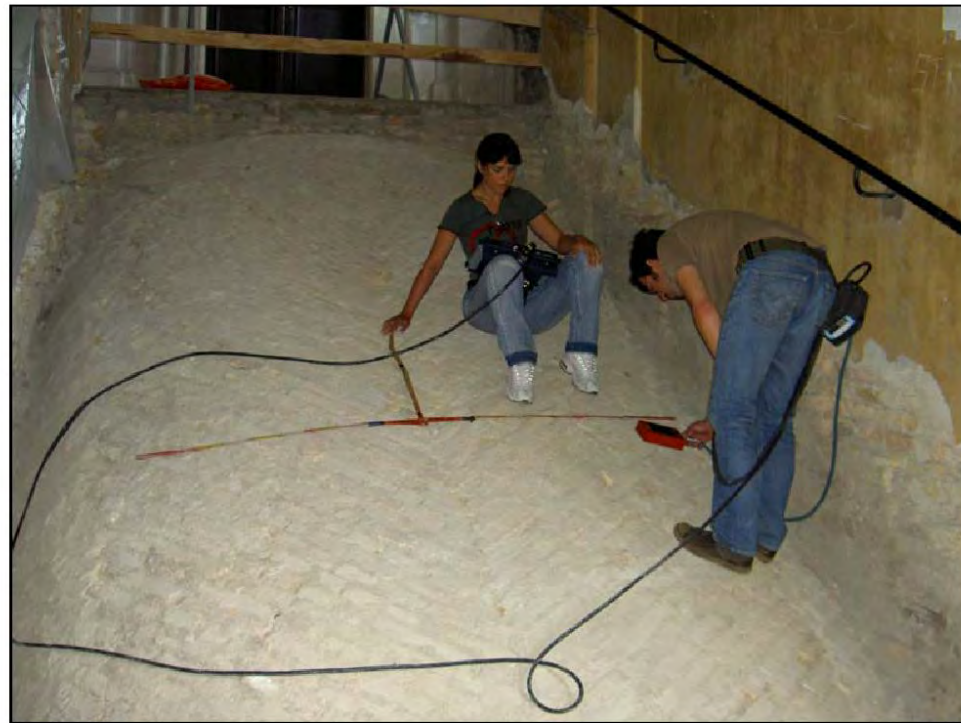
Fig. 8 - Rilievo georadar precedente l'intervento di consolidamento
