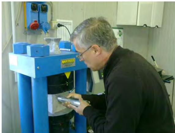
Fig. 2. a) Pressa per prove di schiacciamento e prova sclerometrica; b) prova ultrasonica
