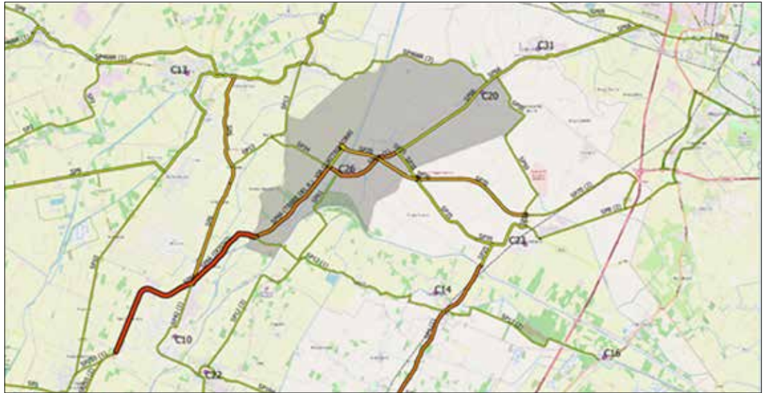
Figura 46. Distribuzione dei flussi di traffico giornalieri generata dal modello TDFM per lo scenario post-liquefazione.
