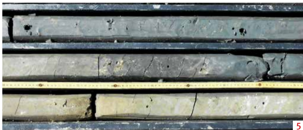
[3] dettaglio di un deposito di canale fluviale caratterizzato da ghiaie prevalenti organizzate secondo una stratificazione incrociata ad alto angolo [4] dettaglio di un deposito di canale fluviale in cui si osservano sabbie organizzate secondo una stratificazione incrociata ad alto angolo [5] dettaglio di un deposito di piana inondabile, osservato in un carotaggio, costituito da argille e limi con accumuli di sostanza organica.
