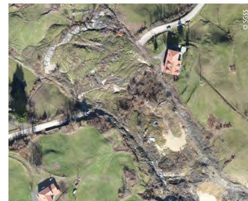
Boceto (Borgo Val di Taro, PR). Scivolamento traslativo nella parte alta, che evolve in colata nella parte medio-bassa dell'accumulo. Litotipi arenacei e argillitici.
