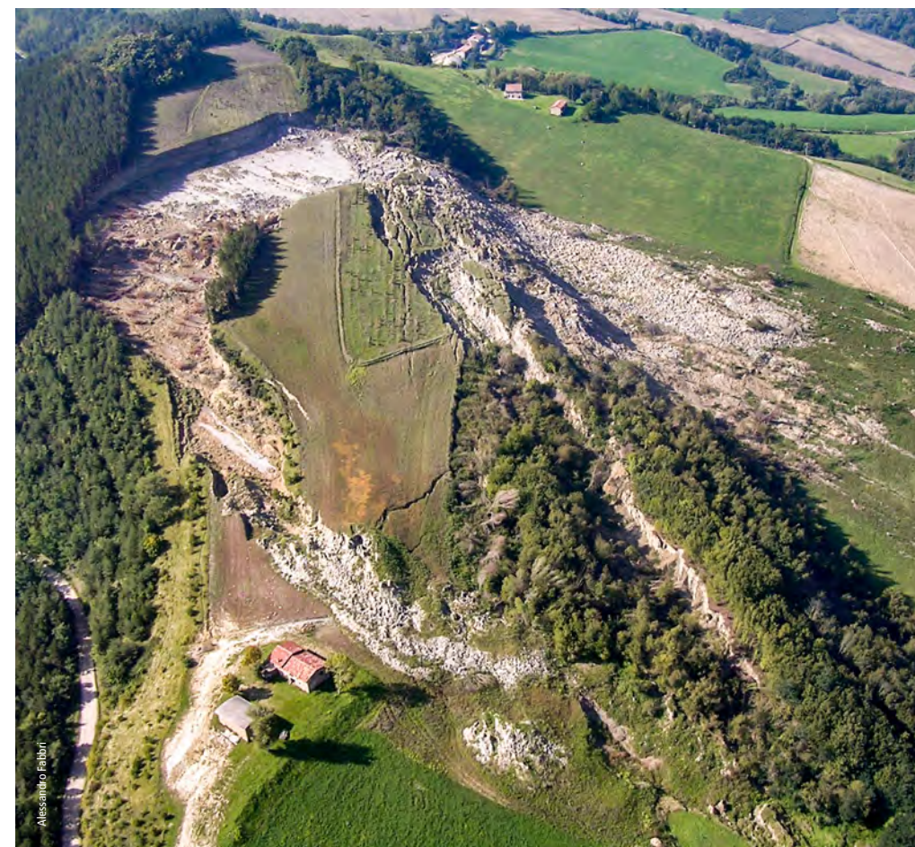
Roncosole (Borgo Tossignano, Casola Val Senio, BO - RA). Scivolamento traslativo nella porzione superiore, sovrapposto a scivolamento-colata in terra. Litotipi arenaceo-pelitici.
