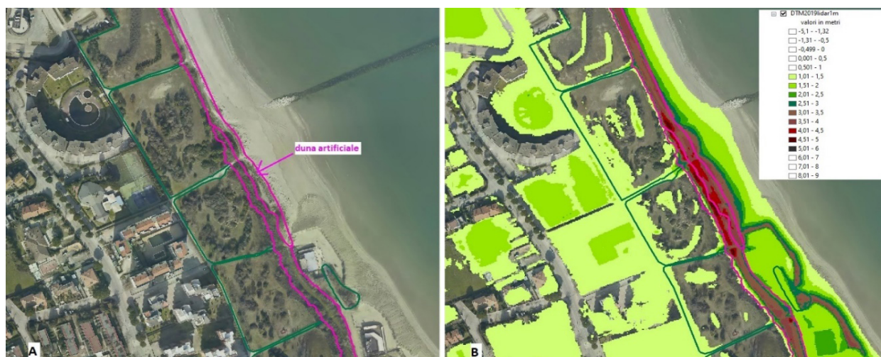
Figura 4 esempio di duna artificiale presente a Lido Adriano (in fig. A ortofoto e in fig. B in rilievo DTM_LI- DAR) (1) .
