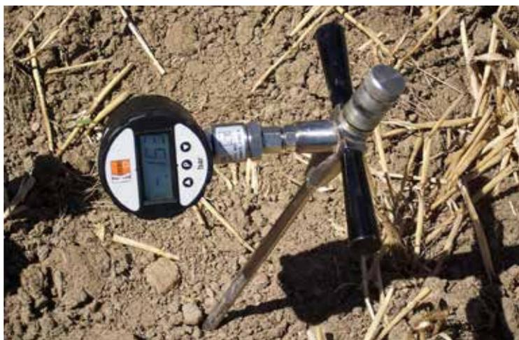
[15] Misurazione con tensiometro a risposta rapida (fonte: Suolo e cantieri. Stato della tecnica e della prassi UFAM 2015 - J.P. Clément).
