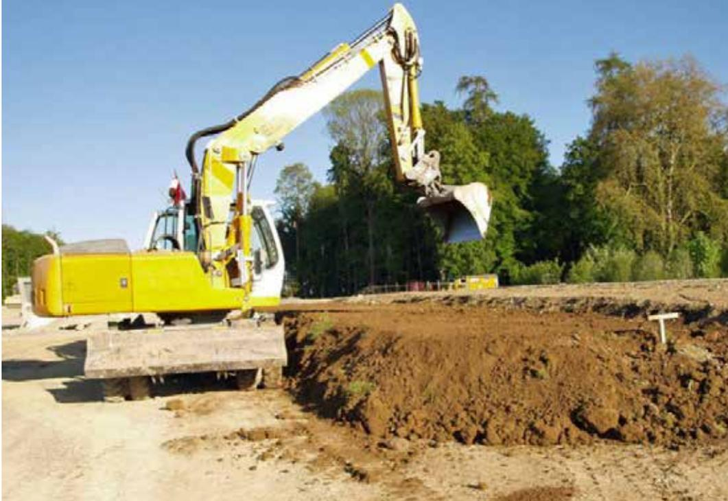
[17] Escavatore idraulico cingolato munito di benna (fonte: Suolo e cantieri. Stato della tecnica e della prassi UFAM 2015 - R. Quartier)
