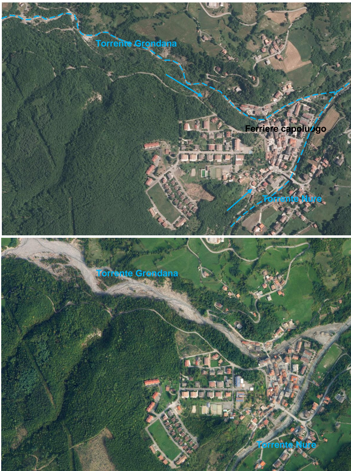
Figura 19 - Confluenza torrente Grondana con il fondovalle del torrente Nure prima del nubifragio (pannello superiore) e dopo il nubifragio (pannello inferiore). Da evidenziare il significativo mutamento della conformazione dell'alveo del torrente Grondana, affluente in sinistra del torrente Nure, avvenuto nel lasso di tempo di poche ore a causa del nubifragio. La copertura vegetale asportata, in combinazione con il materiale alluvionale eroso, ha spesso amplificato i danni lungo i torrenti sia di rango gerarchico minore che maggiore.
