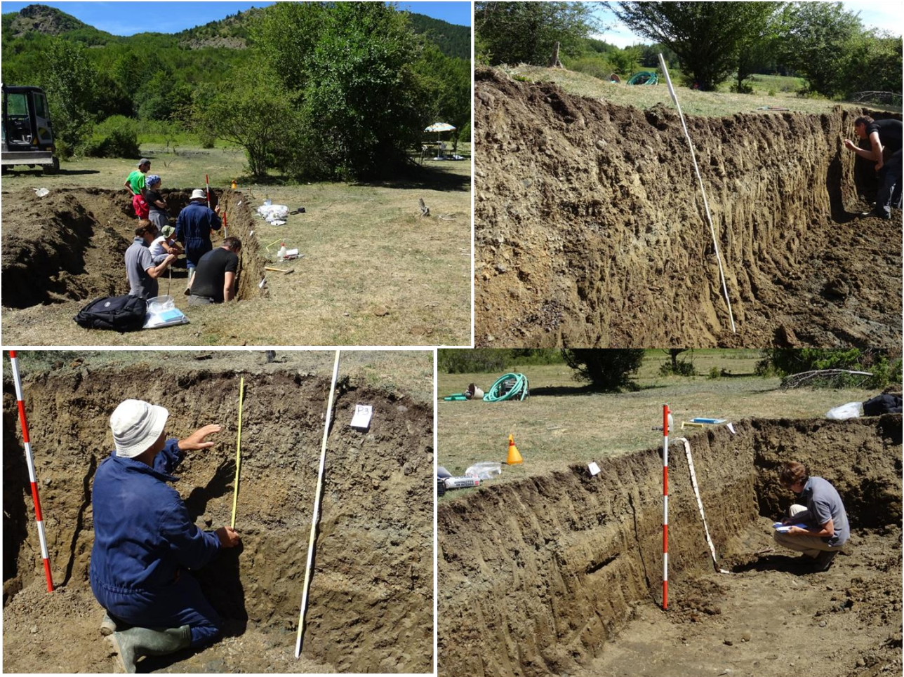
Fig.4: Lettura della stratigrafia delle unità affioranti in trincea, con rilevazione dei livelli ghiaiosi, imputabili ad eventi di forti afflussi meteorici nella conca del lago
