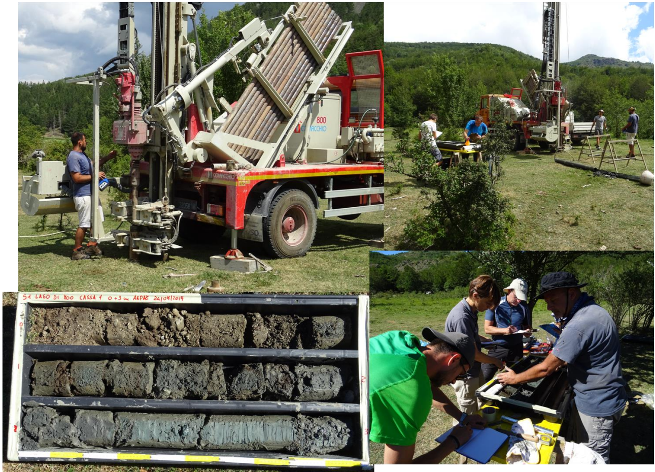
Fig.3: Operazioni di carotaggio e lettura dei campioni prelevati nel primo punto individuato S1
