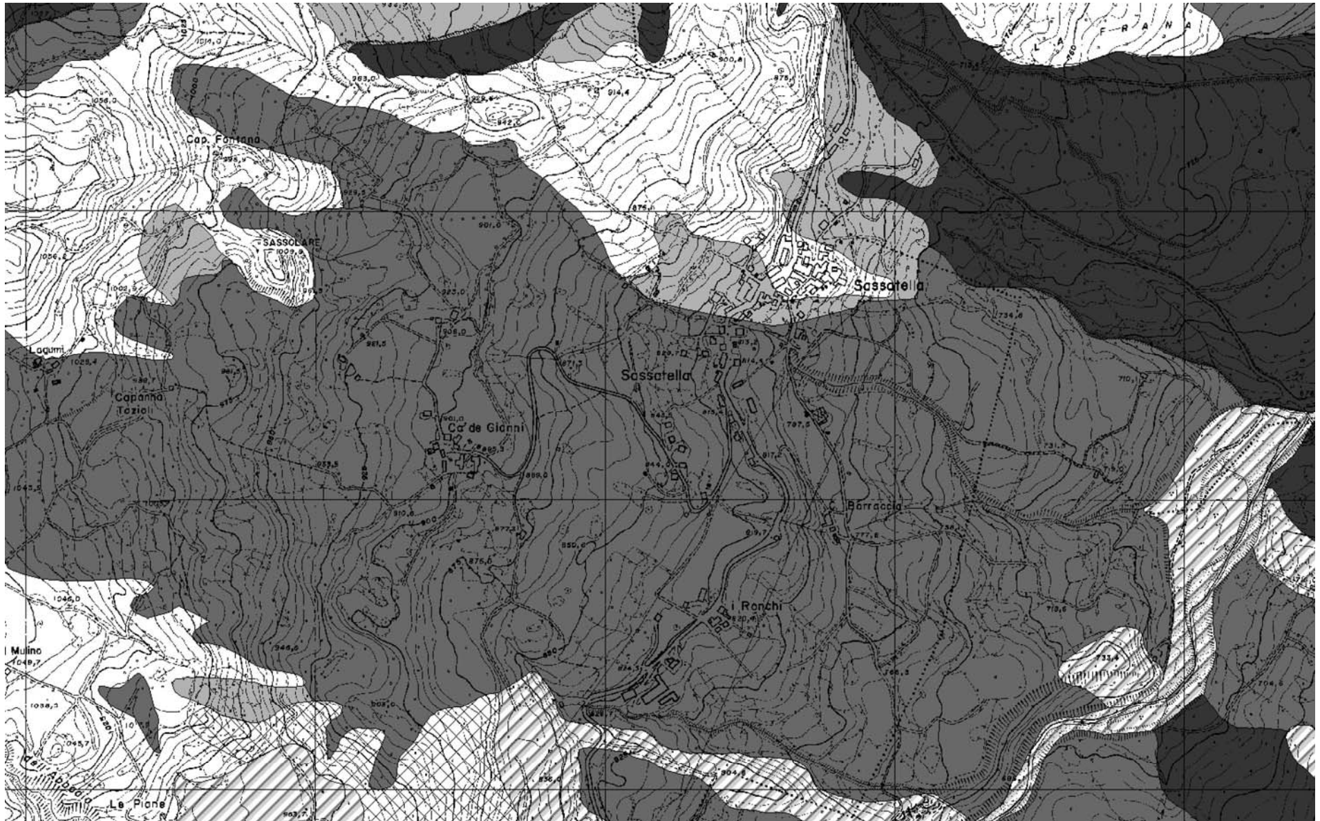
Inventario del dissesto attuale in scala 1:10000. Legenda – grigio scuro: frana attiva; grigio medio: frana quiescente; grigio chiaro: copertura di detrito; retinato (quadrati): scivolamento in blocco; retinato (linee): altre tipologie.
