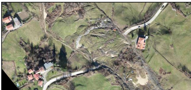
Fig. 43: immagine zenitale della parte medio bassa della frana (foto gentilmente concessa dal STB Affluenti del Po). Notare la traslazione verso valle della strada.
