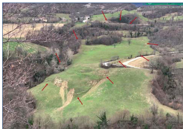
Figura 18. Panoramica della frana di Corneto (Verghereto, FC); le frecce indicano le fratture perimetrali (foto del SGSS).
