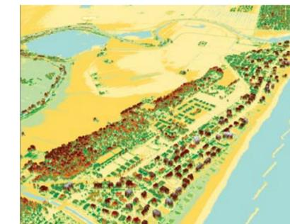
Modello digitale di superficie della foce del fiume Savio, ottenuto con tecnica LIDAR.
