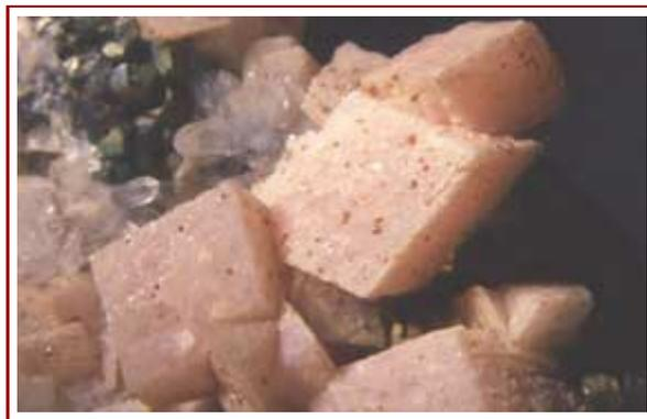
*FIG. 4 - ESEMPIO DI MINERALE DEL SISTEMA TRIGONALE: LA RODOCROSITE.*
