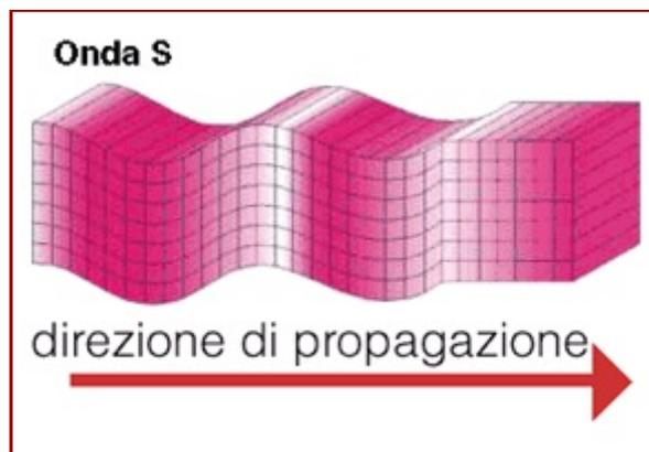
FIG. 2 - PROPAGAZIONE DELL'ONDA TRASVERSALE ONDA S.
