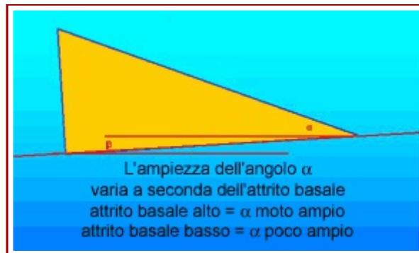
FIG. 3 - ANGOLO DEL CUNEO; A = ANGOLO DELLA PARTE EMERSA DEL CUNEO; B = ANGOLO DELLA PARTE CHE SI IMMERGE (TRASCURABILE POICHÉ È MOLTO PICCOLO); L'AMPIEZZA DELL'ANGOLO A CAMBIA IN BASE ALL'ATTRITO BASALE.
