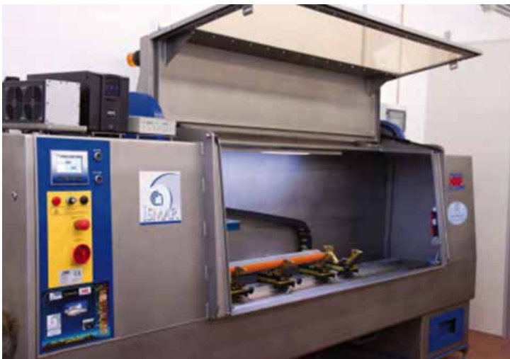
Figura 7.1. Core scanner Avaatech, strumento utilizzato nel laboratorio della sede di Bologna ISMAR CNR.
