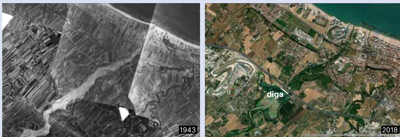
Figura 9.4. La costruzione della diga sul fiume Conca, costruita nei primi anni '70, ha profondamente modificato il corso d'acqua che, negli anni '40 presentava una morfologia 'braided' (a canali intrecciati), per poi divenire un canale singolo e stretto.
