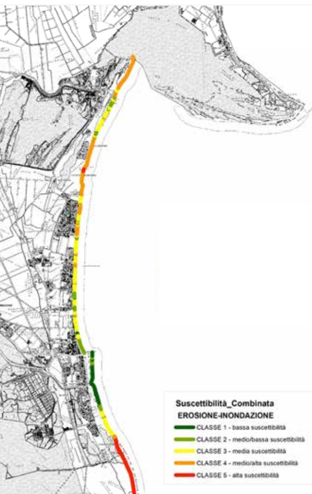
Figura B.4. Indicatore del livello di suscettibilità combinata all'inondazione e all'erosione lungo la costa ferrarese [1].
