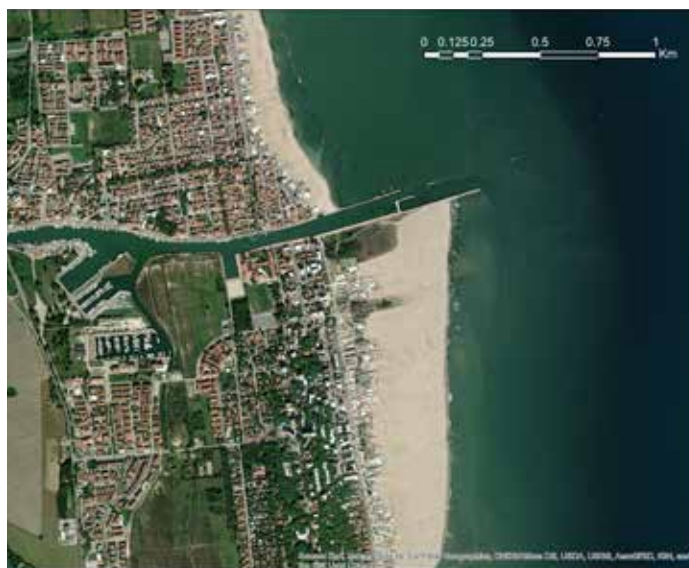
Figura 3.6. Crescita asimmetrica della spiaggia a sud dei moli di Porto Garibaldi, dovuta al trasporto verso nord delle correnti litoranee (2020).
