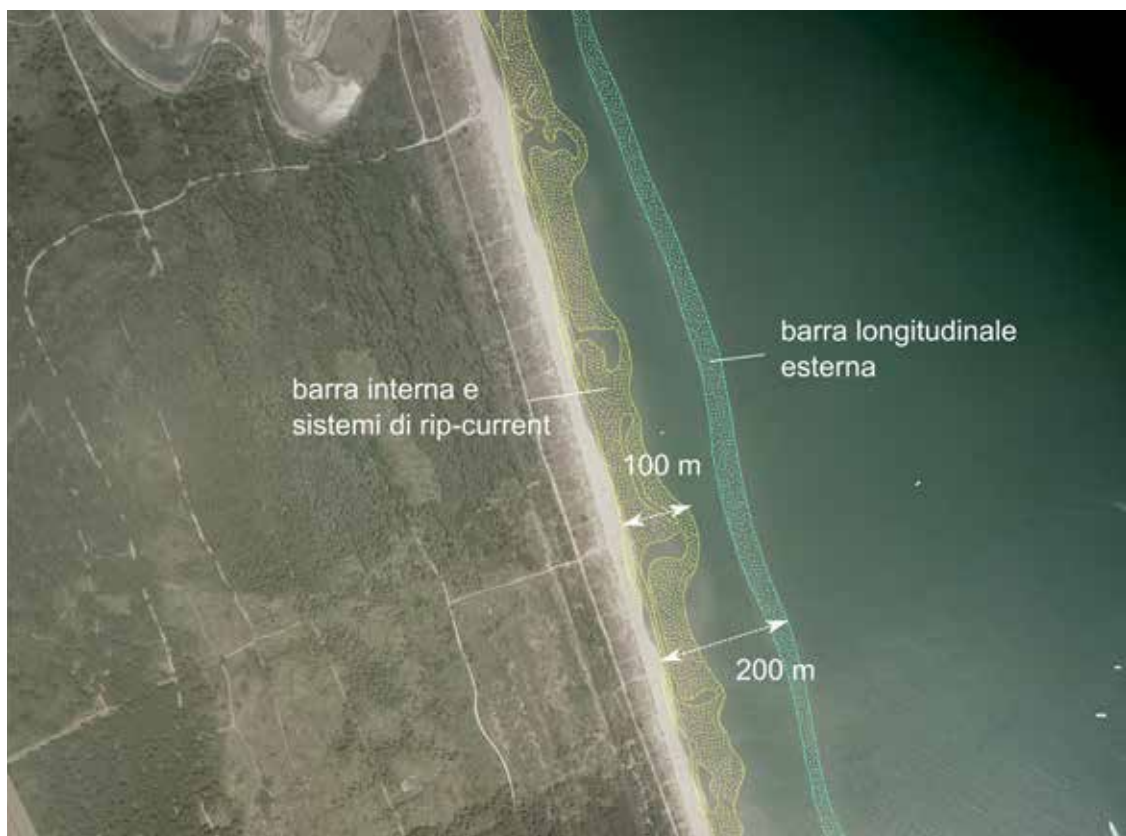
Figura 2.9. Barra longitudinale esterna e sistema di barre e canali di rip current (foce Bevano).
