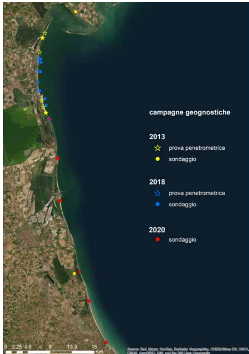
Figura 6.10. Ubicazione delle prove geognostiche acquisite a terra e a mare tra il 2013 e il 2020.
