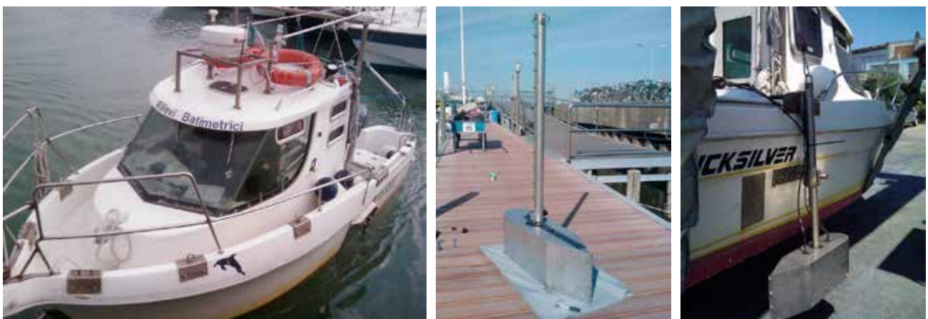
Figura 6.6. Motobarca San Rocco, al centro e a destra trasduttori e assemblaggio del sistema di acquisizione.
