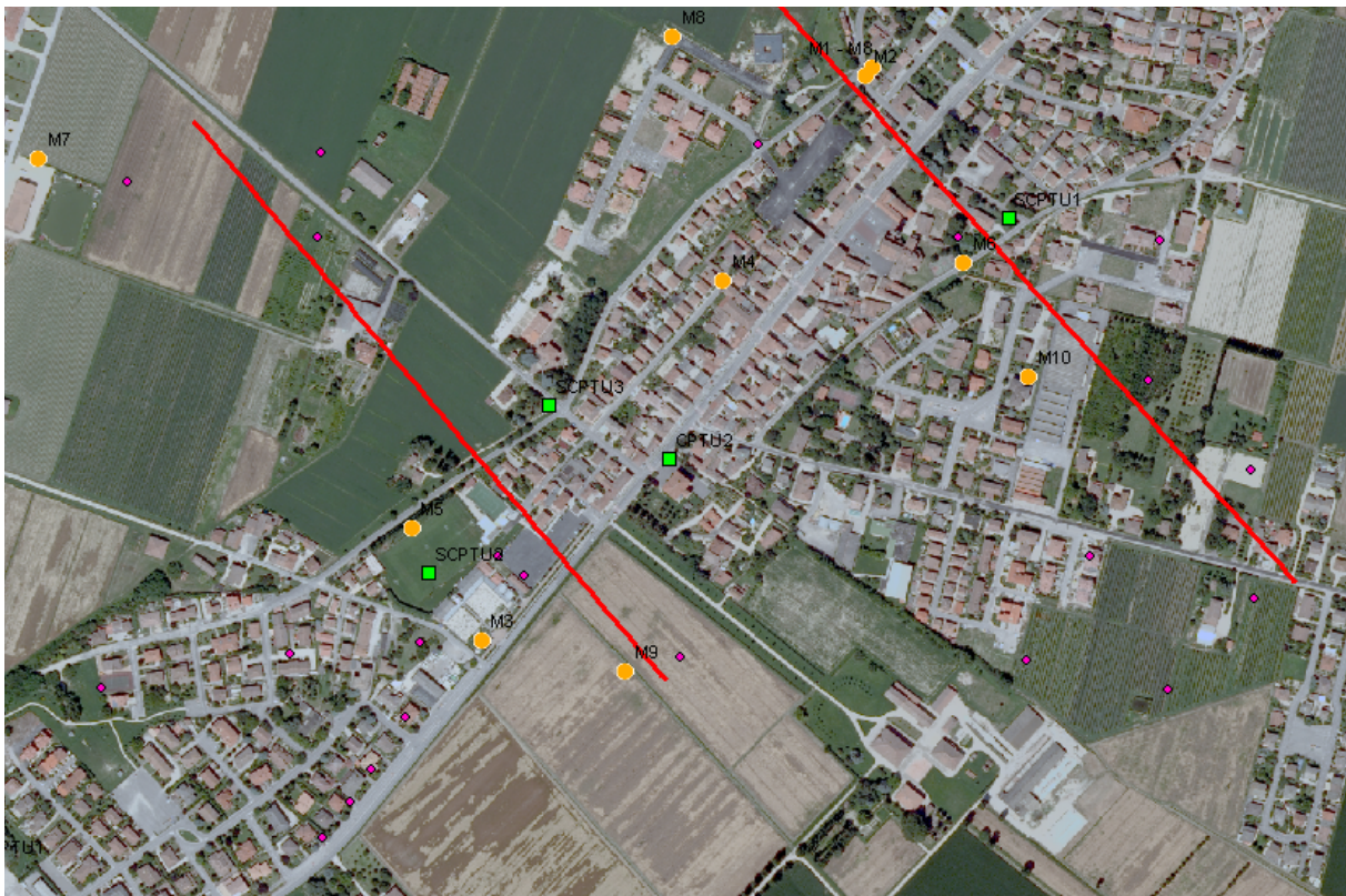
Figura 3: Ubicazione delle tracce delle sezioni geologiche di Mirabello e delle prove geognostiche utilizzate (cerchio arancione = sondaggio, quadrato verde = prova penetrometrica, punto fucsia = dato stratigrafico da banca dati geognostica)
