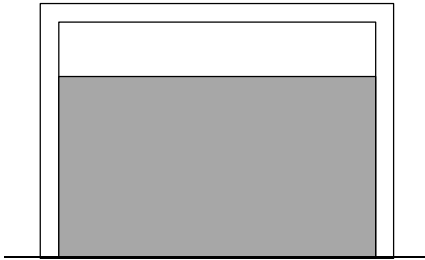
Figura 8-4: Disposizione non corretta della tamponatura
