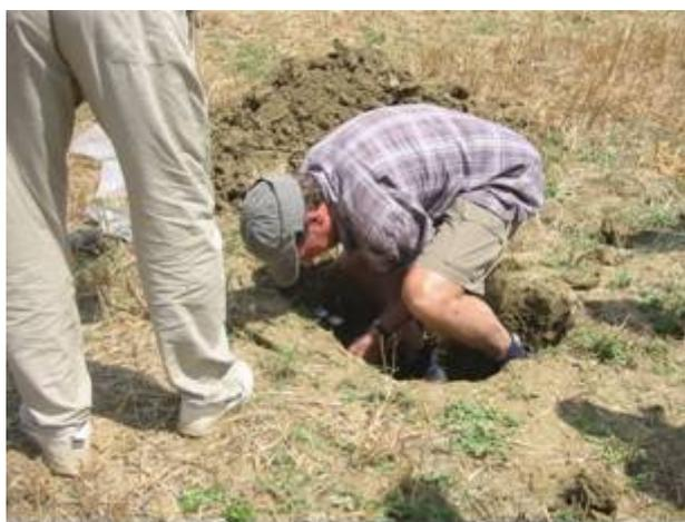
Operazioni di prelievo fustella per determinazione della Densità apparente all’interno del minipit
