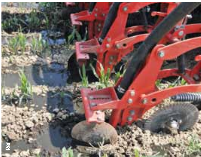
Particolare di attrezzatura per la distribuzione di liquame a bassa emissione
