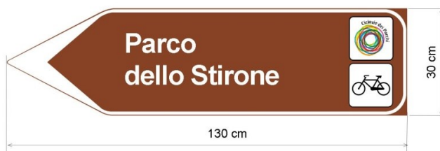
Fig 4: Segnale di direzione per avviamento a Ciclovie del Parco ottenuto dai segnali turistici per contesti extraurbani (Tabella II 14a DPR 495/92)
