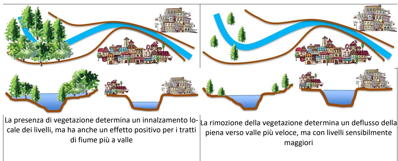
Figura 3: Gestione della vegetazione ai fini di mantenere la scabrezza del tratto adeguata all'efficienza idraulica dell'asta fluviale (Sara Pavan, Gianluca Zanichelli - Roma 2016).
