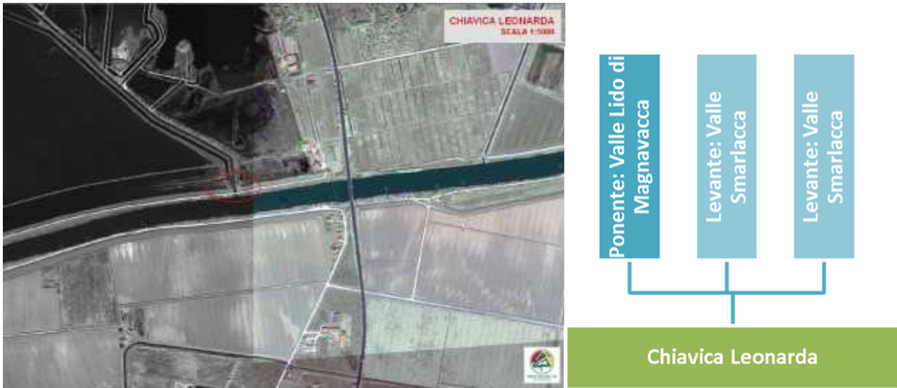
Figura 25: Localizzazione e schema Chiavica Leonarda a tre luci, le due luci di levante alimentano la Valle Smarlacca (privata), quella di ponente alimenta Valle Lido di Magnavacca.
