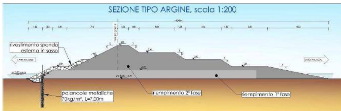
FIGURA 48 – SEZIONE TIPO ARGINE (FONTE: AUTORITÀ PORTUALE DI RAVENNA)
