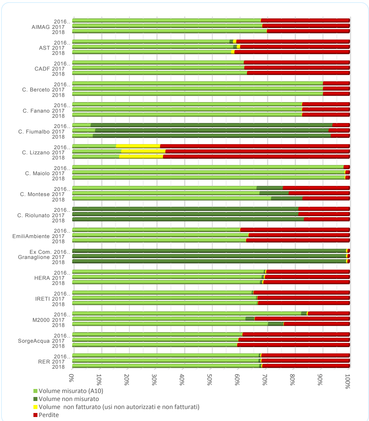
Grafico 3 - Il sistema di distribuzione dell'acqua potabile: confronti tra l'acqua immessa in rete, quella distribuita, quella fatturata e quella persa – 2016-18
