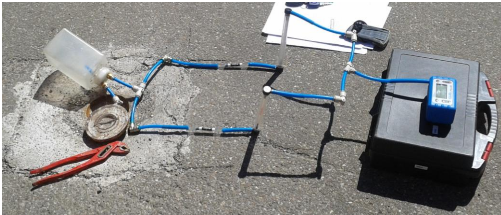
Figura 9 b): Applicazione dello schema tipo linea di campionamento soil gas di Figura 9 a)
