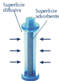
Figura 12: Campionatore a diffusione radiale – Radiello
