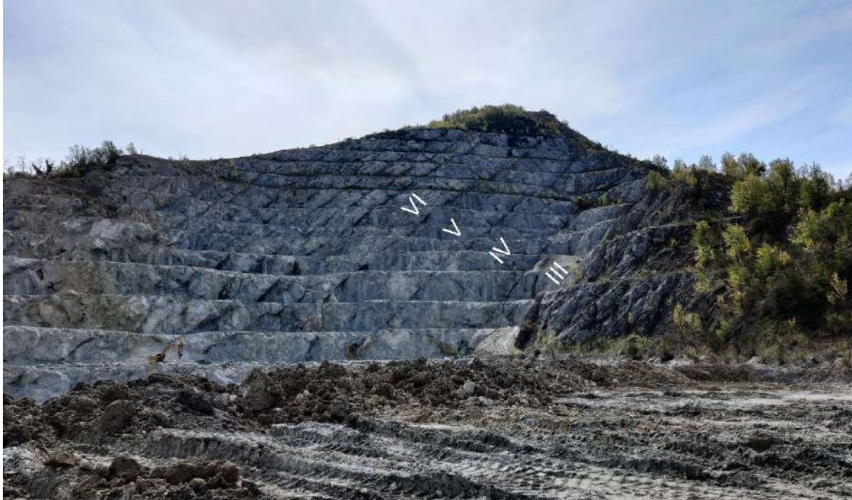
Figura 7-6 – Particolare del fronte di cava sul lato orientale. Sono evidenziati i 4 banchi gessosi di maggior spessore e qualità mineraria (dal III° al VI°)
