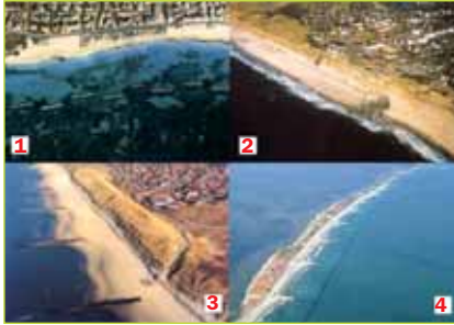
Fotomontaggio 1. Tipi di strutture di difesa (fotografia 1, strutture parallele; fotografia 2, ripascimento; fotografia 3, penelli; fotografia 4, intervento composito)
