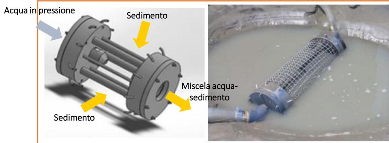
Portata di alimentazione: 43,5 m<sup>3</sup>/h, di cui 27 m<sup>3</sup>/h sull'ugello centrale.
