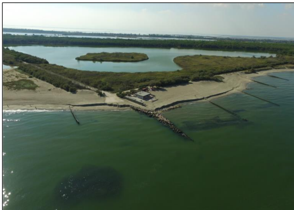
Figura I.3.3-22: Lido di Spina Sud (Ferrara): pennelli in pali di legno e in roccia (2016)
