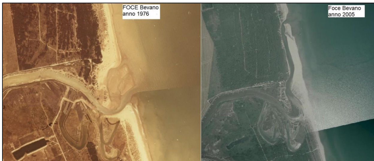
Figura I.2.2-13: evoluzione di foce torrente Bevano dal 1976, in cui si osserva un delta di marea con barre di foce emergenti, che evolve in una foce con freccia litoranea estesa circa 500 m verso nord (anno 2005).
