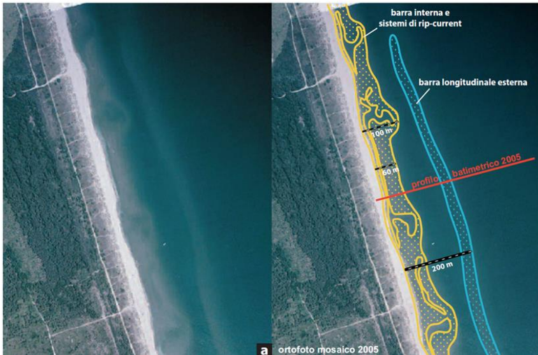
Figura 1.2.2-9: tipologico sistema di barre che caratterizzano la spiaggia sommersa interna. A sinistra evidenze profili barre da foto aerea, a destra ricostruzione degli elementi individuati e loro denominazione
