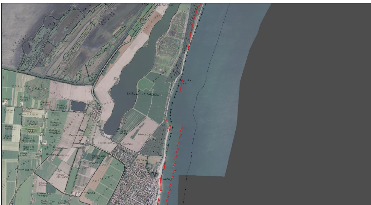
Figura I.2.1-4: La dividente demaniale localmente interrotta in corrispondenza di forte erosione nei pressi di Lido delle Nazioni (Scala originale 1:25.000).
