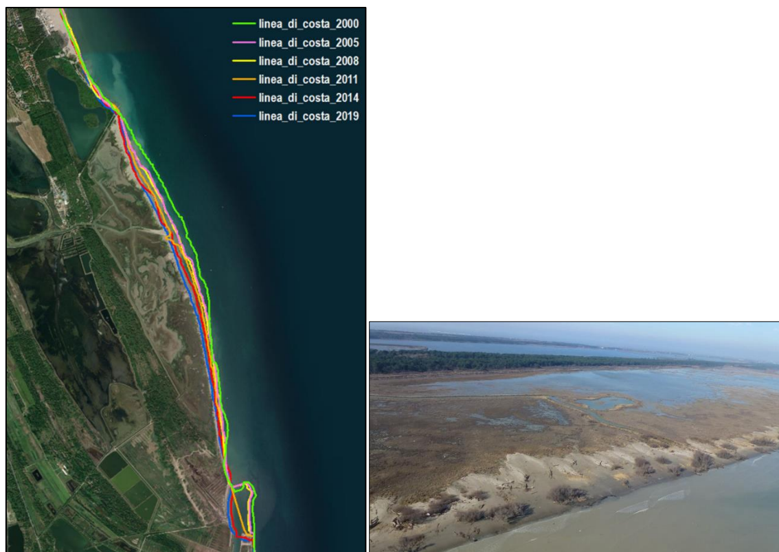
Figura I.2.4-13: linee di riva presso il settore nord della foce del Reno (Vene di Bellocchio) nel periodo 2000-2019; a sin è riportata una foto dell'ambiente costiero in questione: si tratta di una sottile spiaggia, costituita da una stretta battigia e da ampi ventagli di washover, che borda un'estesa zona umida.
