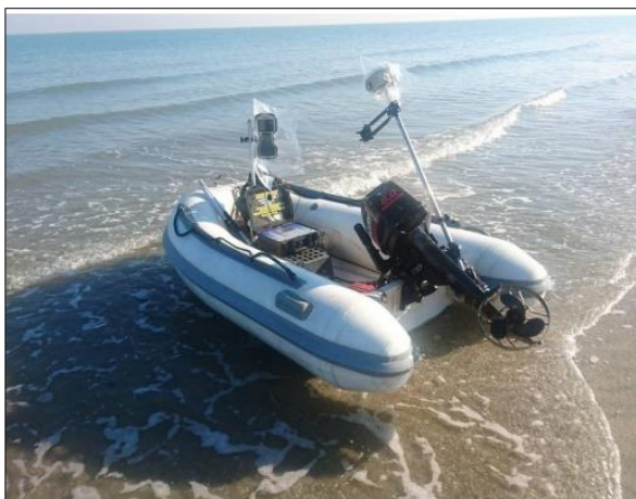
Figura I.4.2-13: Imbarcazione attrezzata con sistema multibeam e GPS (sinistra) e gommone per rilievo singlebeam e GPS per il monitoraggio degli interventi di ripascimento
