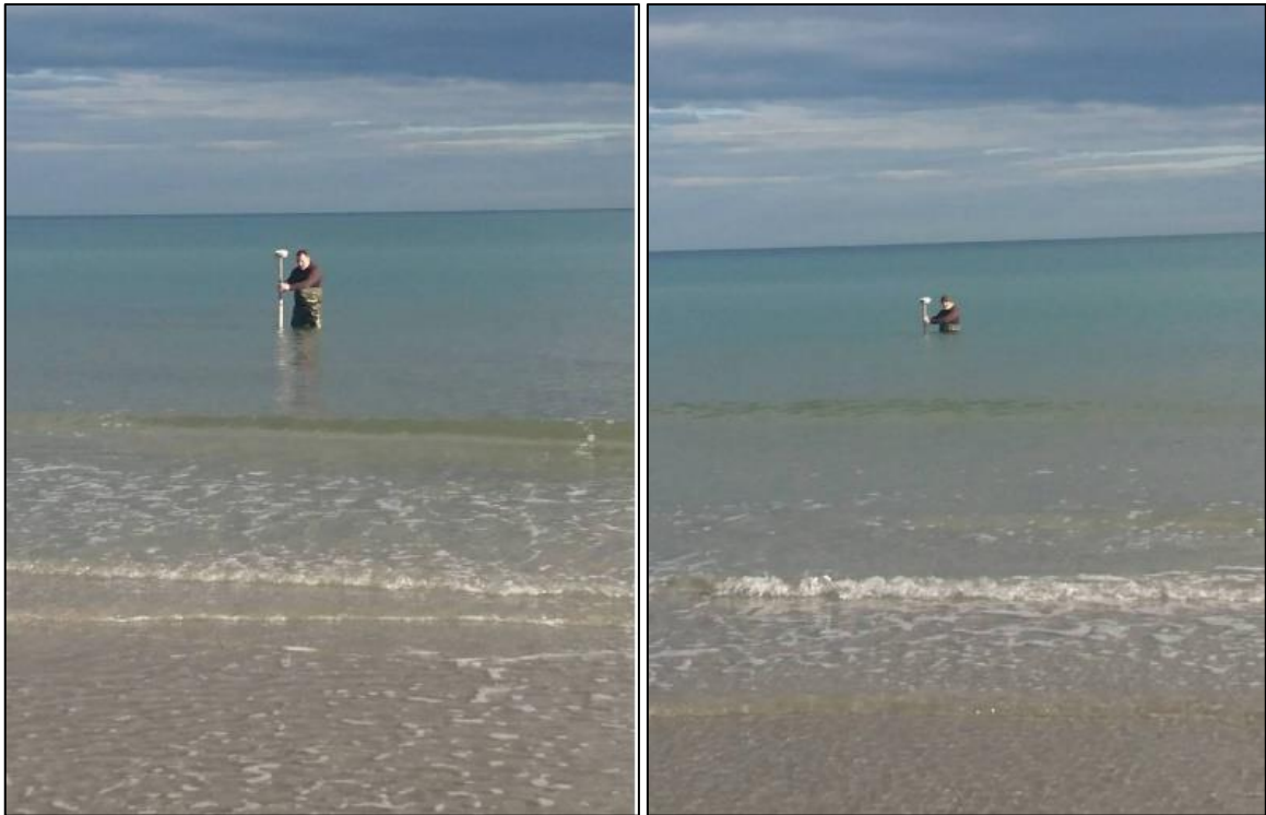
Figura I.4.2-14: Rilievo con GNSS della spiaggia emersa e prima fascia sommersa
