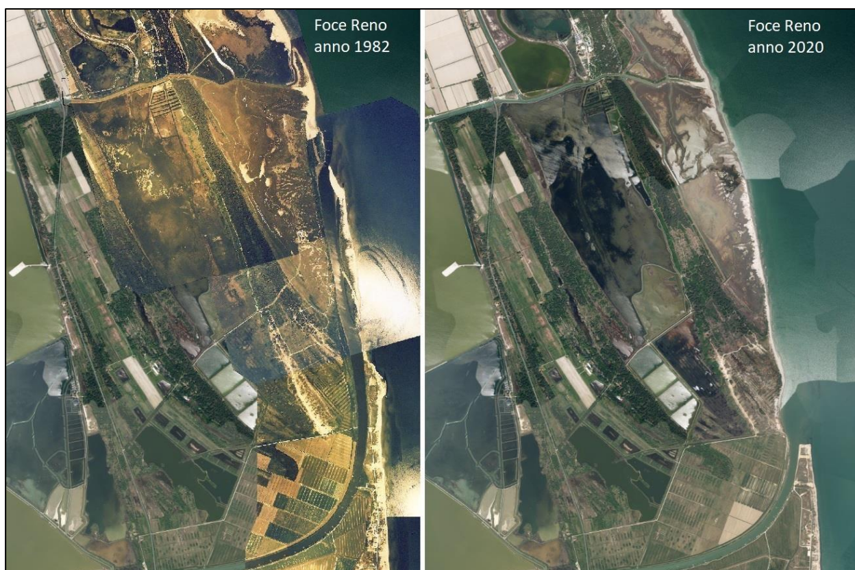
Figura I.2.2-12: evoluzione di foce Reno dal 1982, in cui si osserva la presenza di uso spit esteso circa 3 km, al 2020. La freccia litoranea è completamente scomparsa per effetto dell'erosione
