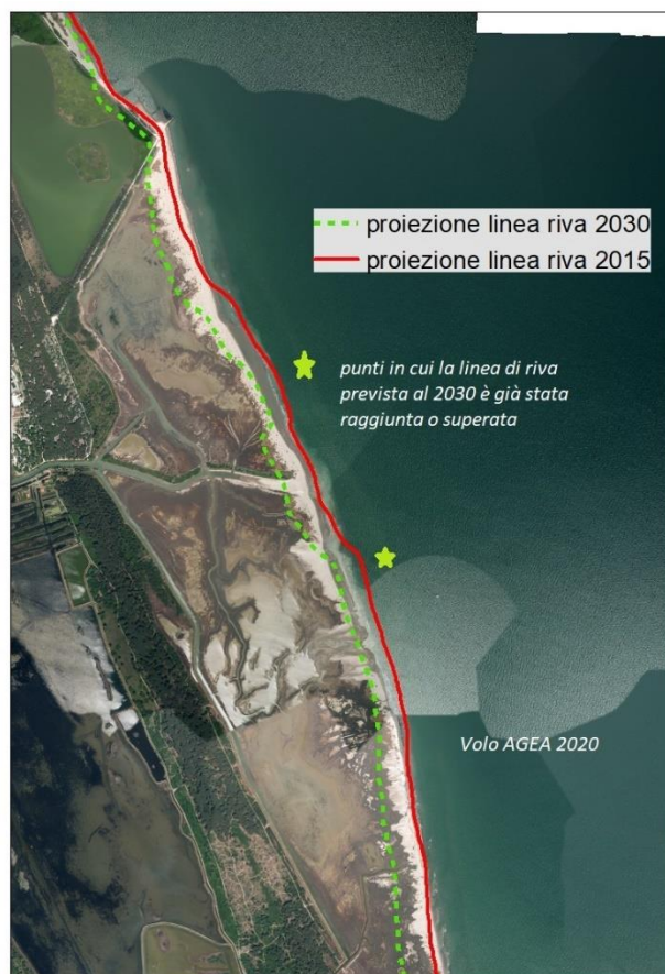
Figura I.3.4-8: L'immagine a sinistra rappresenta la proiezione della linea di riva al 2015 sovrapposta al volo aereo Costa 2005. Nell'immagine a fianco la stessa linea e la proiezione al 2030 sono proiettate sull'immagine del Volo Agea 2014.
