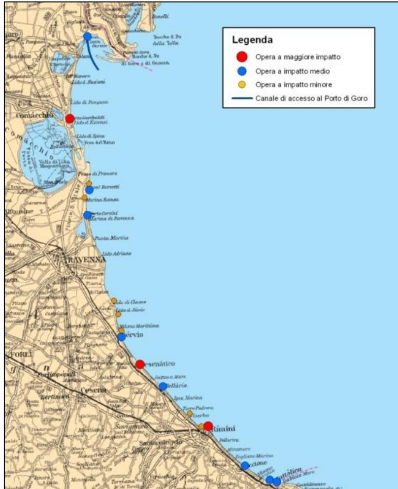
Figura I.3.3-2: Distribuzione delle opere trasversali che interferiscono con la dinamica costiera lungo il litorale emiliano-romagnolo (2020)
