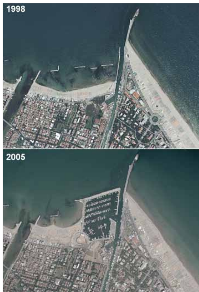
figura 27 La darsena di Rimini, costruita a ridosso del molo nord del porto canale
