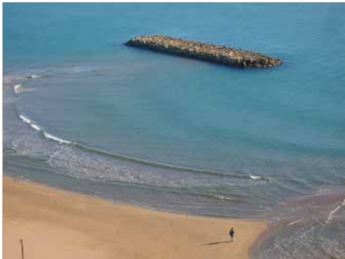
figura 22 un tombolo al retro di una scogliera parallela emersa
