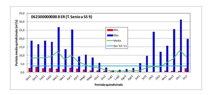
Come i precedenti grafici avevano mostrato sono rilevanti le differenze di deflusso rilevante anche a cadenza quindicinale fra gli undici anni analizzati. Si tratta, molto semplicemente, di prendere atto che il valore medio di portata è limitatamente rappresentativo, a causa di una elevata deviazione standard.
