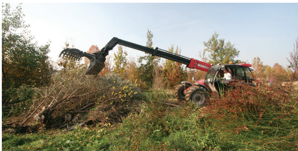
Figura 114 La valorizzazione economica delle siepi messe a dimora lungo i canali richiede l'utilizzo di appropriati mezzi meccanici per il taglio e la raccolta del materiale legnoso. (Foto: Bruno Boz)
