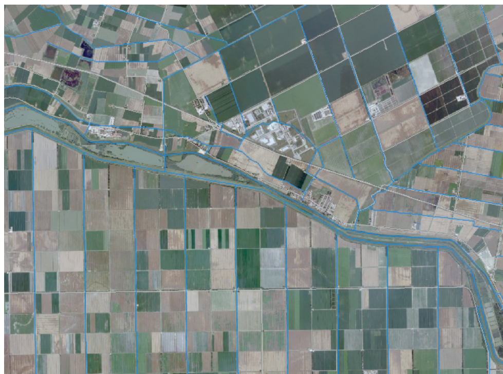
Figura2 La sistemazione idraulica dei terreni nella pianura dell'Emilia-Romagna: si nota nella foto la fitta rete di scoline e canali che attraversano il territorio (in blu), rendendo possibile lo scolo delle acque e l'irrigazione dei terreno agricoli.
