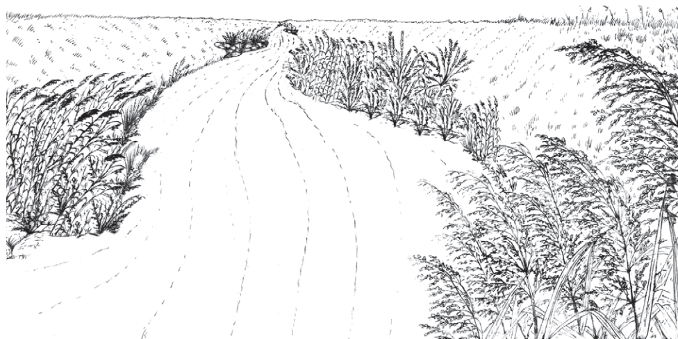
Figura 44 Canale sinuoso, colonizzato da vegetazione palustre, all'interno del quale le acque scorrono a minor velocità rispetto ad un percorso rettilineo, aumentando così i tempi di residenza e la capacità autodepurativa del canale. (Disegno: Massimo Milandri)
